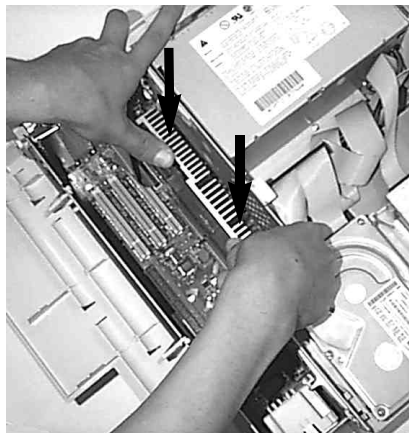
Abbildung 8 Einsetzen der MACCELERATE!750 Beschleunigerkarte
