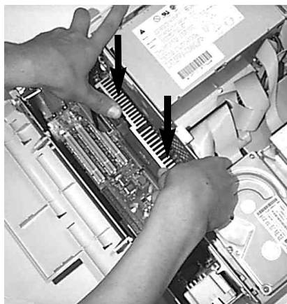
Abbildung 8. Einsetzen der MAccelerate!604e Beschleunigerkarte
